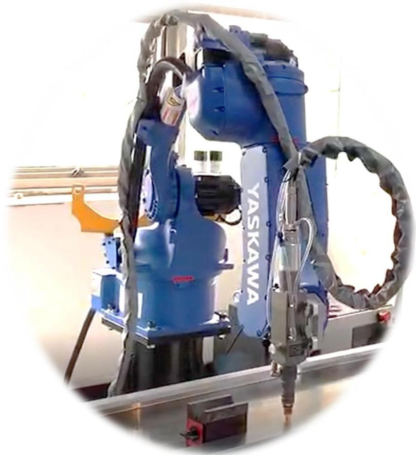
**激光加工原理：**通过激光设备产生具有较高能量密度的激光束，照射在被加工材料表面上，材料表面吸收激光能量，在照射区域内产生热激发过程，从而使材料表面（或涂层）温度上升，产生变态、熔融、烧蚀等现象，从而实现激光打标、雕刻、焊接、切割、清洗等功能。
